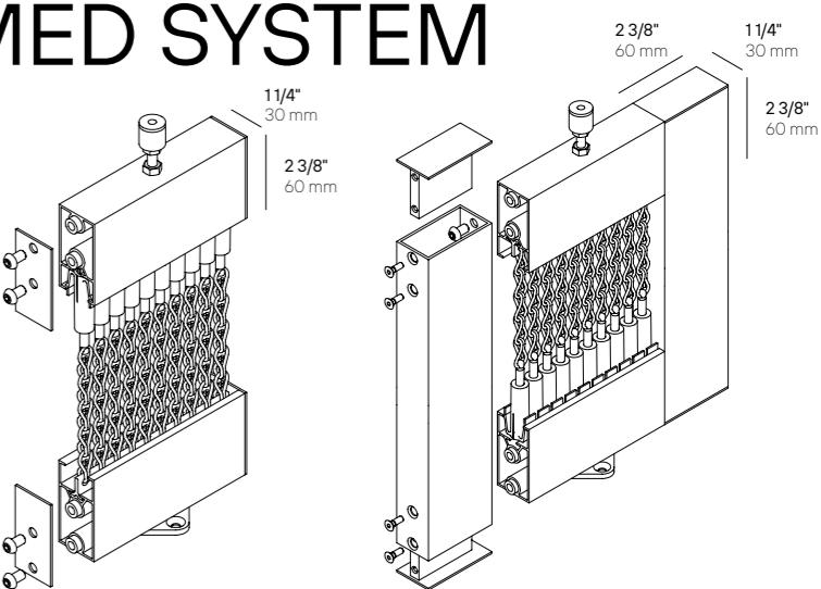
TAUT SYSTEM LENGTHWISE OR FRAMED SISTEMA TENSADO LONGITUDINAL O ENMARCADO
